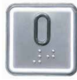
SQV Wymiary: 33,8 mm × 33,8 mm EN81.70 Braille 24V, NO Kolor podświetlenia: biały
