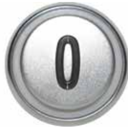
RDA Średnica 30mm PN-EN81.70 Brak braille 24V, NO/NC Kolor podświetlenia: Czerwony/ Niebieski
