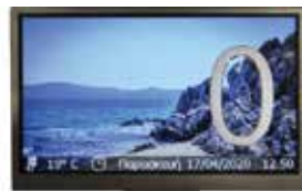
TFT 5 Wyświetlacz kolorowy (Res.: W 480px, H 272px, głębia koloru 24bity) Połączenie WIFI Wyświetlanie przystanków Czas- Data Temperatura Strzałki kierunku jazdy 2 języki (Angielski - Grecki)
