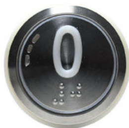
RDB Durchmesser 36mm EN81.70 Brailleschrift 24V, NO Farbe der Beleuchtung: Blau
