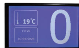
Graphic LCD Stockwerk Nummer Uhrzeit Datum Temperatur Richtungspfeile
